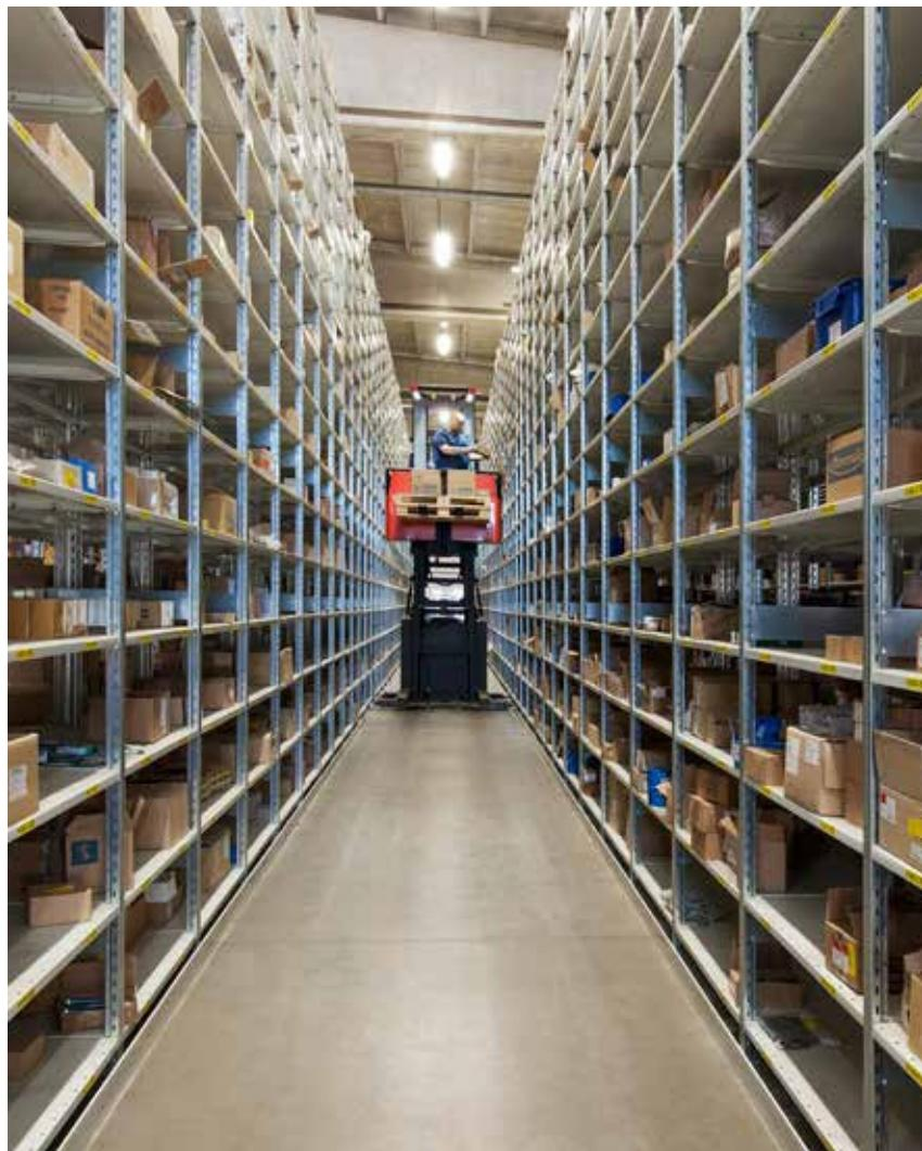
Высотные полочные системы и стеллажи с узкими межстеллажными проездами обычно применяются на круглосуточно действующих складах. Погрузочно-разгрузочные работы здесь производятся вручную с помощью подъемных платформ или автоматическими кранами штабелерами.
