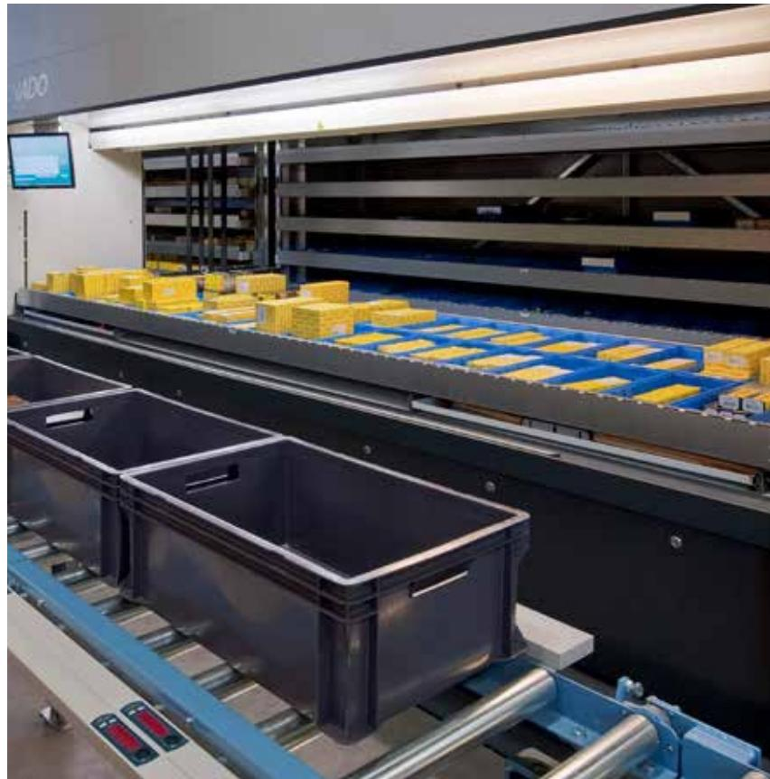
Автоматизированная система лифтового типа TORNADO – это динамическая система хранения и обработки продукции, которая повышает эффективность комплектования заказов до 65%, а также позволяет увеличить объем хранения товаров до 70% на той же площади.
