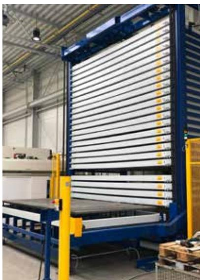
Автоматизированная система хранения GMH предназначена для хранения и обработки различных видов тяжелых грузов, в частности, продукции из металла.
