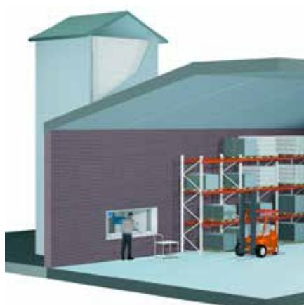
Установка за пределами здания с возможностью работы изнутри помещения
